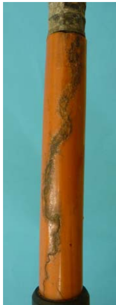
Kabeļa paraugs ar plaisāšanu
